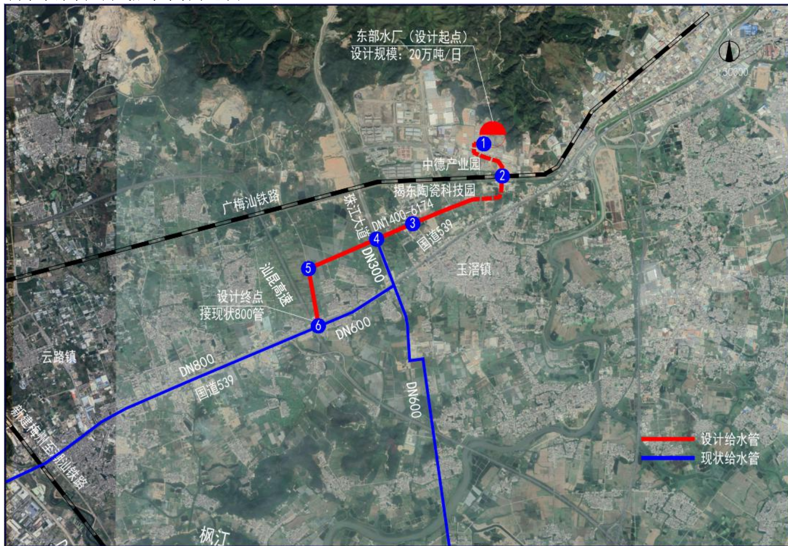
附图 7 揭东东部水厂南线配水干管示意图
